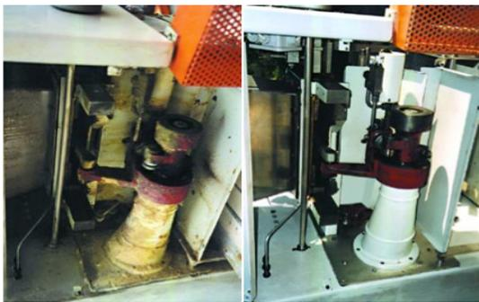
**Trockeneisstrahlen** Mit Hochdruck wird schonend, trocken und ohne Strahlmittelrückstände bis in die kleinste Oberfläche der Schmutz entfernt. Als Strahlmittel wird festes Kohlendioxid (Trockeneis) mit einer Temperatur von -78,9 Grad Celsius verwendet. Der Vorteil liegt im schonenden Verfahren, die Oberfläche wird dabei in keiner Weise verändert.
